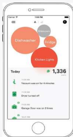
Fig. 3. La 'app' de Sense visualiza los datos en tiempo real como burbujas que contienen el nombre del dispositivo. Un muro describe los eventos del día e incluirá recomendaciones para la conservación energética.
