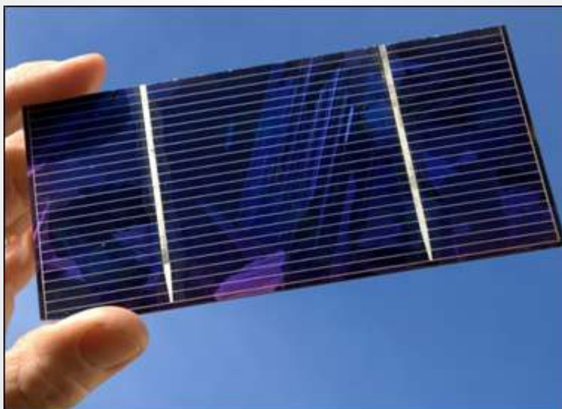
Fig. 1. Celda Solar para la fabricación de paneles fotovoltaicos
