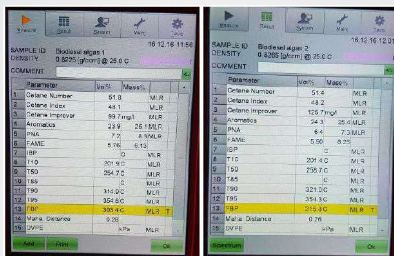
Fig. 3. Parámetros de Calidad del aceite con analizador de combustible de alta presión ERASPEC
