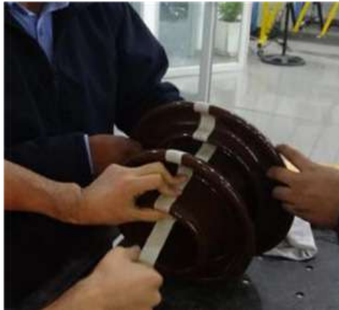
Fig. 2. Aisladores de porcelana tipo pin clase ANSI 56-4 para red de media tensión (Cortesía de Isoladores Santa Terezinha).
