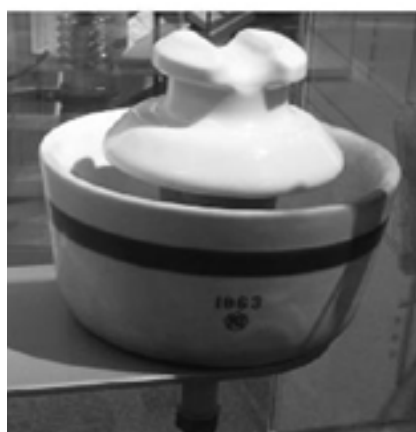
Fig. 1. Aislador cerámico de baños en aceite (Museo Histórico de Energía Eléctrica TEPCO).
