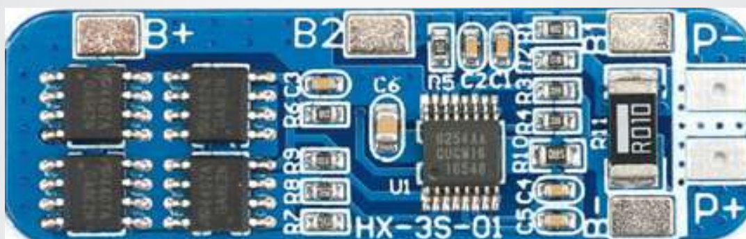
Fig. 1. Sistema de gestión de baterías.
