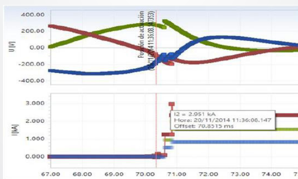
Fig. 7. Sobretensión transitoria a la entrada de un SAI producto de un corte de energía.
