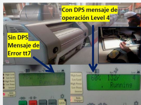
Fig. 9. Procesadora de avena, antes y después de un DPS.
