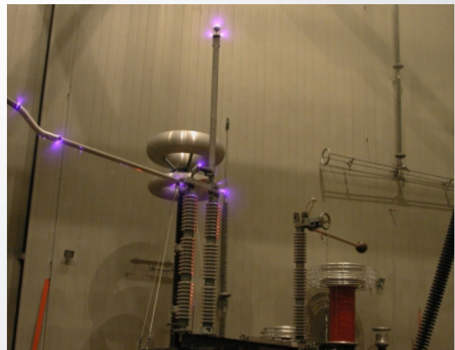
Imagen 5: Efecto corona en ensayos de laboratorio
