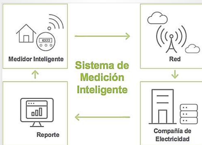
Fig. 1. Esquema general de Sistema de medición Inteligente.
