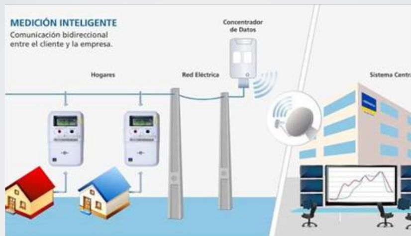
Fig. 3. Comunicación bidireccional, Red de distribución Activa..
