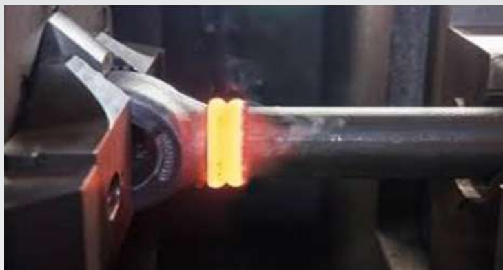
Fig. 1. Soldadura por fricción
