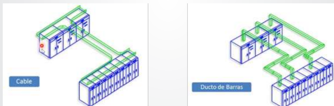
Fig. 2. Estructura de ductos de barras y cables.
