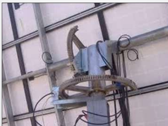
Fig. 11. En esta figura puede observarse claramente los engranajes, uno horizontal encargado de mover el panel durante el día siguiendo el ángulo azimutal, y otro vertical encargado de mover el panel a lo largo del año siguiendo la altura solar.
