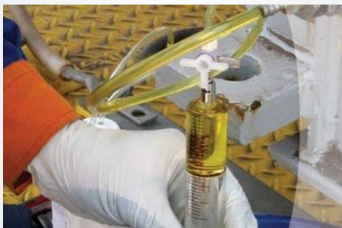
Fig. 2. Recolección de muestra de aceite dieléctrico
