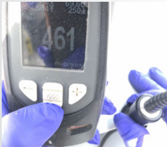
MEDICIÓN DE ESPESOR DE RECUBRIMIENTO EN AISLADOR TIPO BUJE DE GIS.
