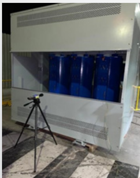
ENSAYO DE TENSION DE IMPULSO TIPO RAYO ONDA NEGATIVA
