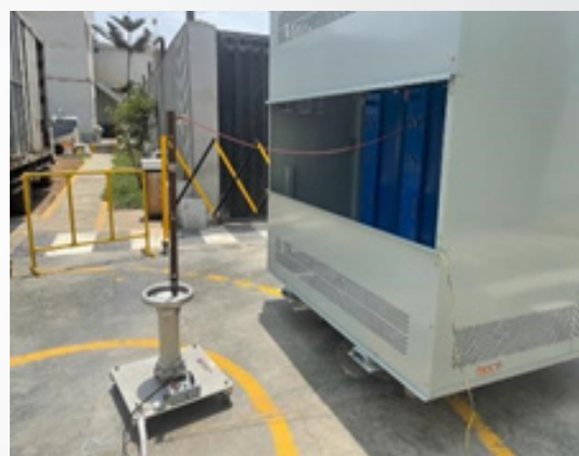
ENSAYO DE DESCARGAS PARCIALES
