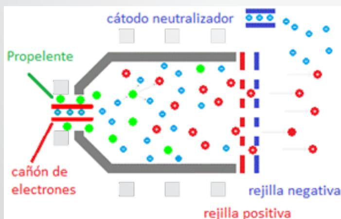
Diagrama esquemático de un impulsor iónico de rejillas
