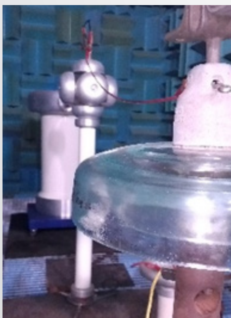
ENSAYO DE TENSION SOSTENIDA A FRECUENCIA INDUSTRIAL EN SECO
