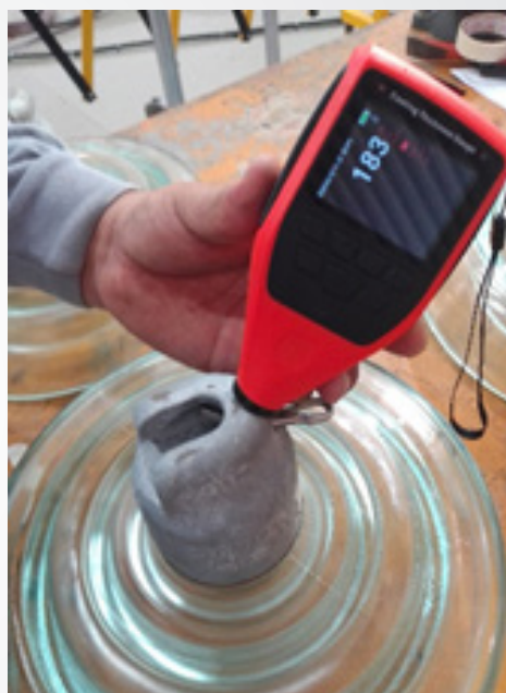
MEDICION DE ESPESOR DE GALVANIZADO
