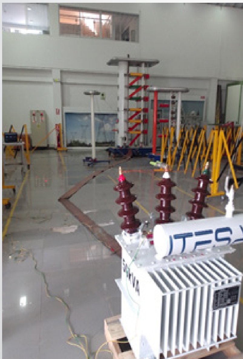
ENSAYO DE TENSION DE IMPULSO TIPO RAYO ONDE NEGATIVA
